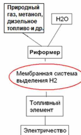
Рис. 1. Схема прямого преобразования химической энергии органического топлива в электричество.
